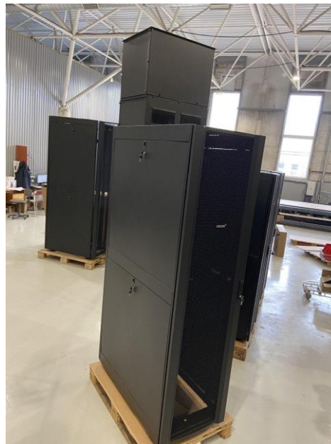
Шкаф с трубой
